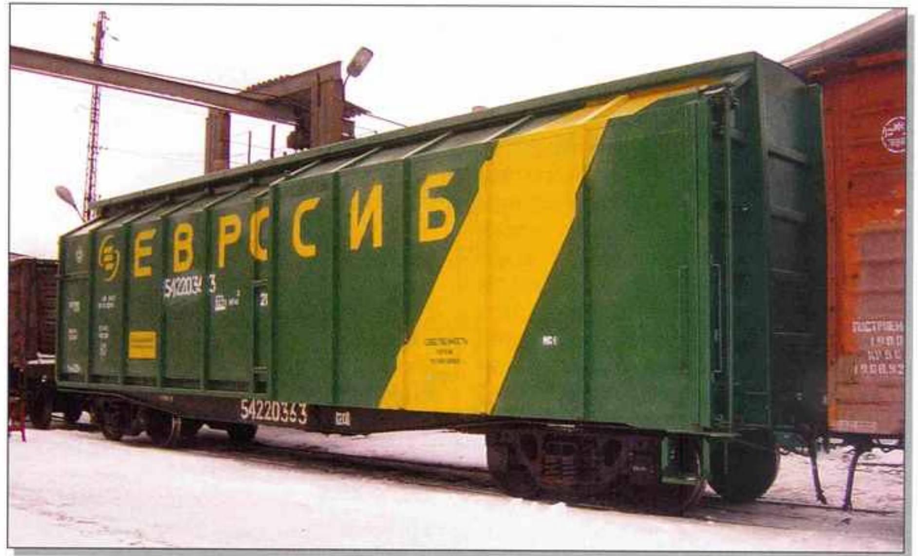
Рис. 6. Специализированная платформа для перевозки грузов, требующих защиты от атмосферных осадков:
