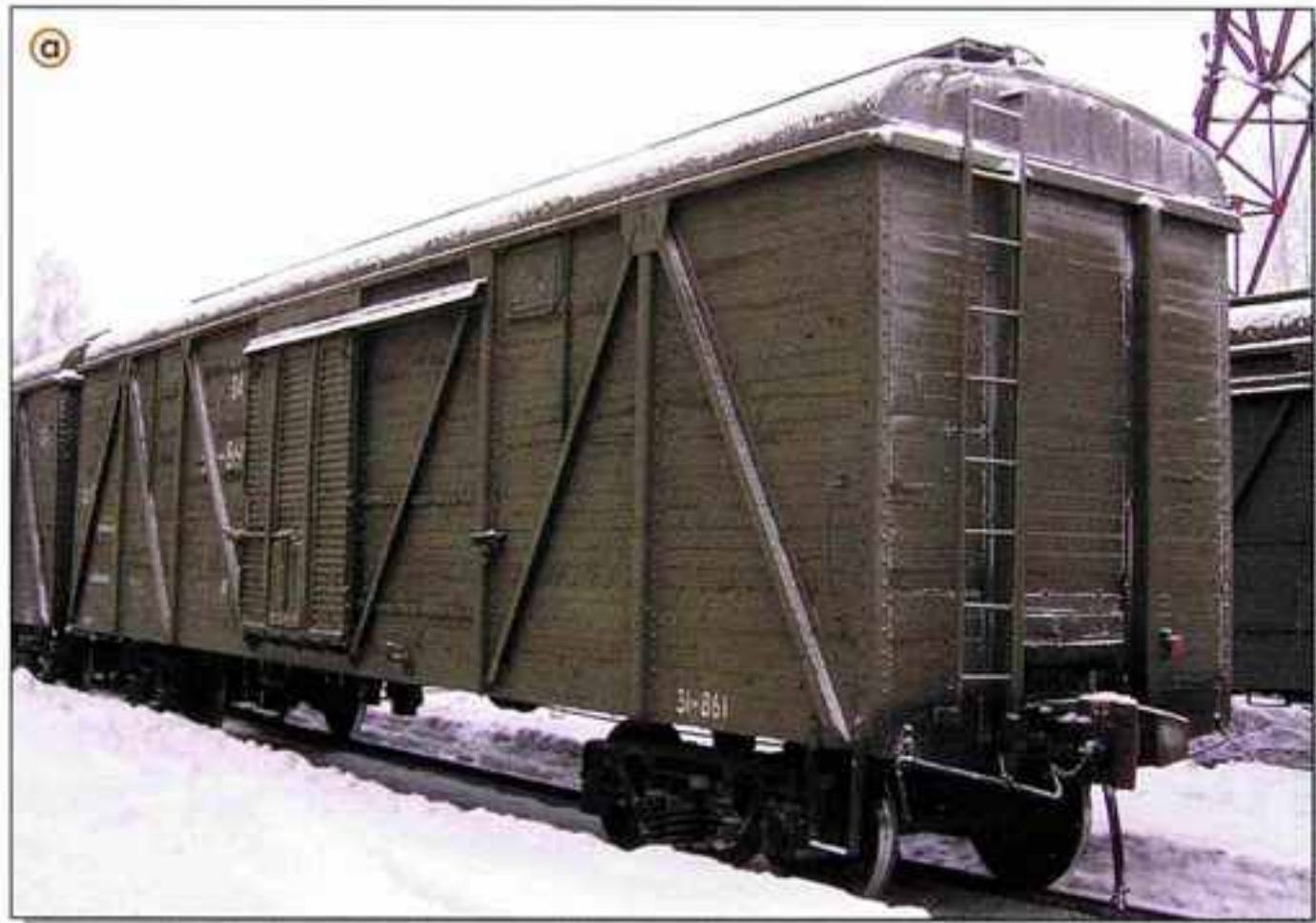
Рис. 1. Крытые универсальные вагоны: а — с деревянной обшивкой стен (объем кузова 120 м 3 , длина по осям сцепления 14,73 м); б — с уширенным дверным проемом и съемной крышей (объем кузова 138 м 3 , длина по осям сцепления 16,97 м)
