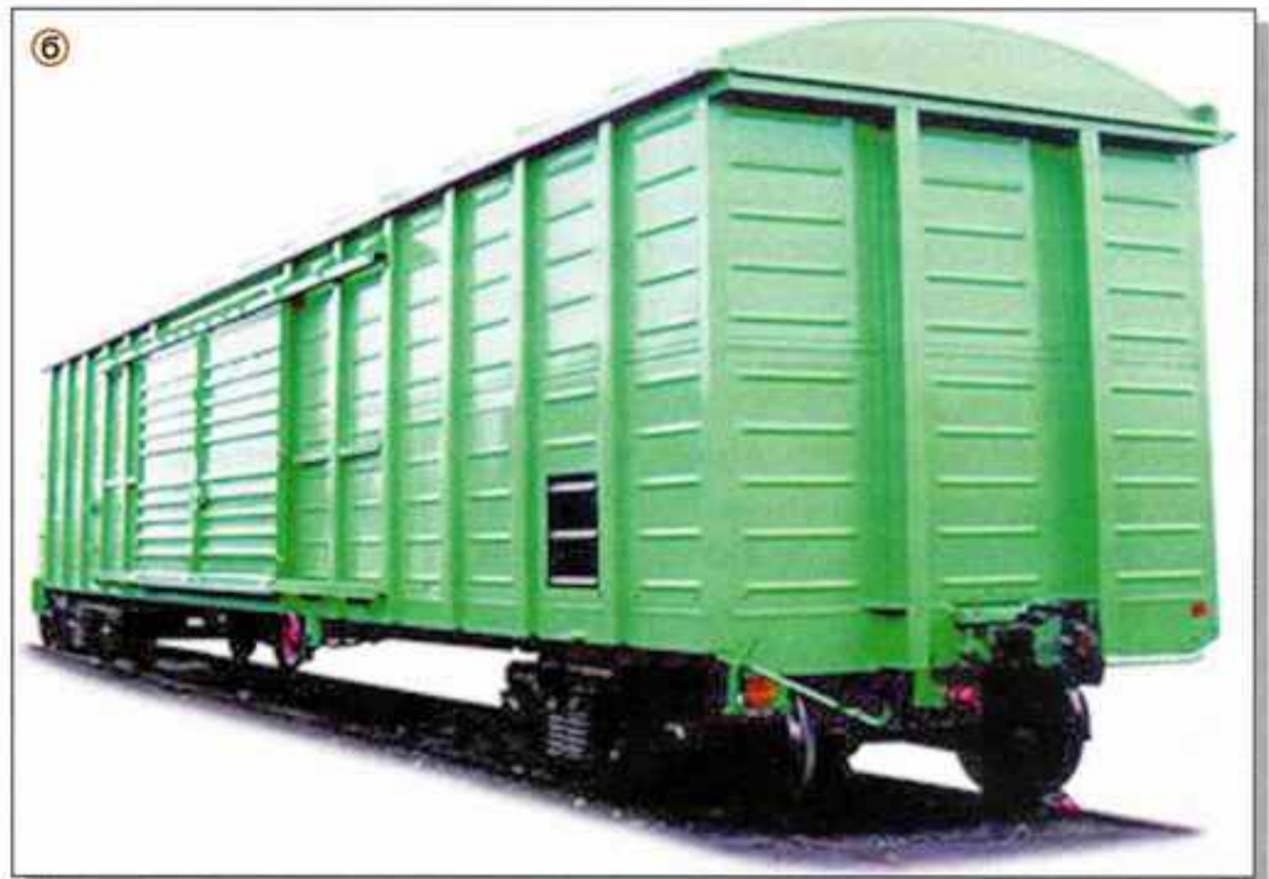
Рис. 1. Крытые универсальные вагоны: а — с деревянной обшивкой стен (объем кузова 120 м 3 , длина по осям сцепления 14,73 м); б — с уширенным дверным проемом и съемной крышей (объем кузова 138 м 3 , длина по осям сцепления 16,97 м)
