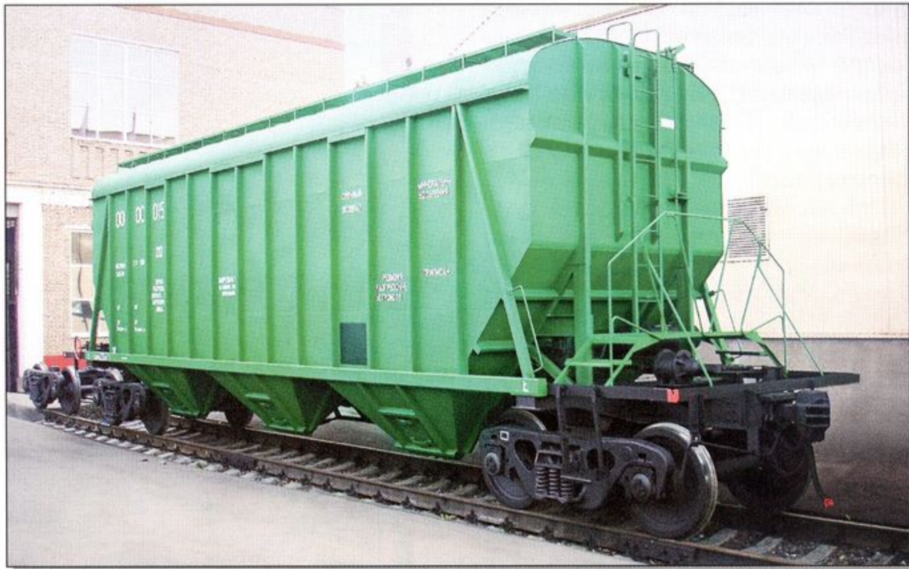
Вагон-хоппер для сыпучих грузов модели 19-9835-01 на тележках «Barber S-2-R» с нагрузкой от оси колесной пары на рельсы 23,5 тс
