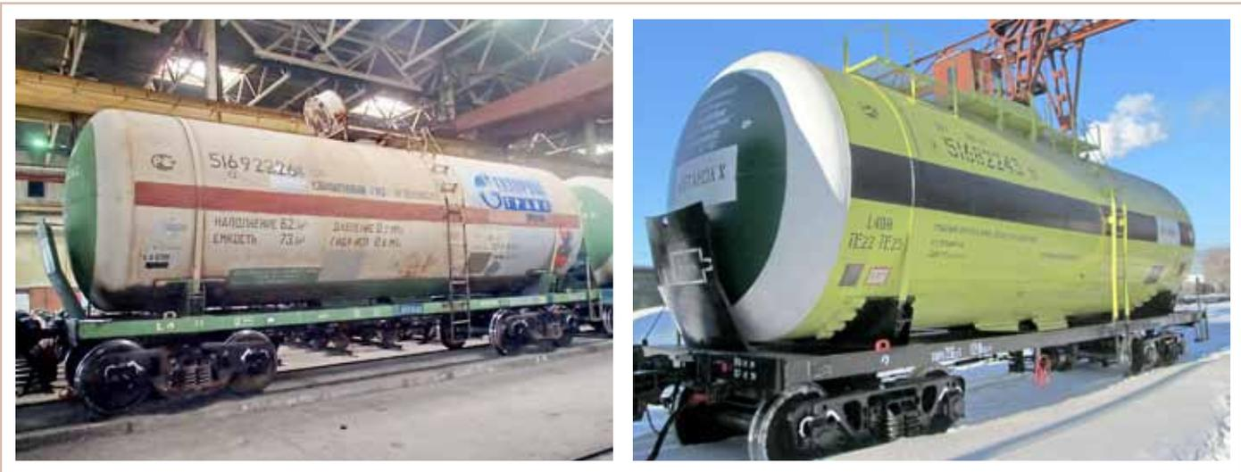
Рис. 6. Вагон-цистерна для пентана (слева; до модернизации модель 15-1520-01) и вагон-цистерна для метанола (после модернизации модель 15-6921)
