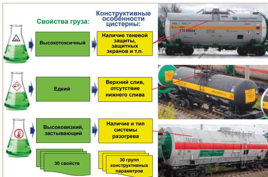
Рис. 2. Влияние свойств груза на конструктивные особенности вагона-цистерны
