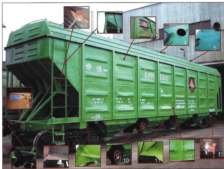
Рис. 4. Основные виды работ по кузову вагона-хоппера при проведении КРП:
