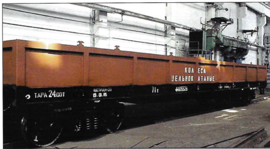
Вагон-платформа для перевозки цельнокатанных колес модели 13-401-25
