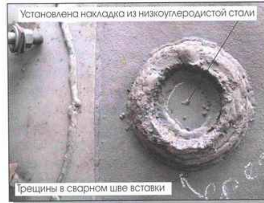
Рис. 4. Дефекты котлов, вызванные ремонтом, выполненным с нарушениями требований нормативных документов
