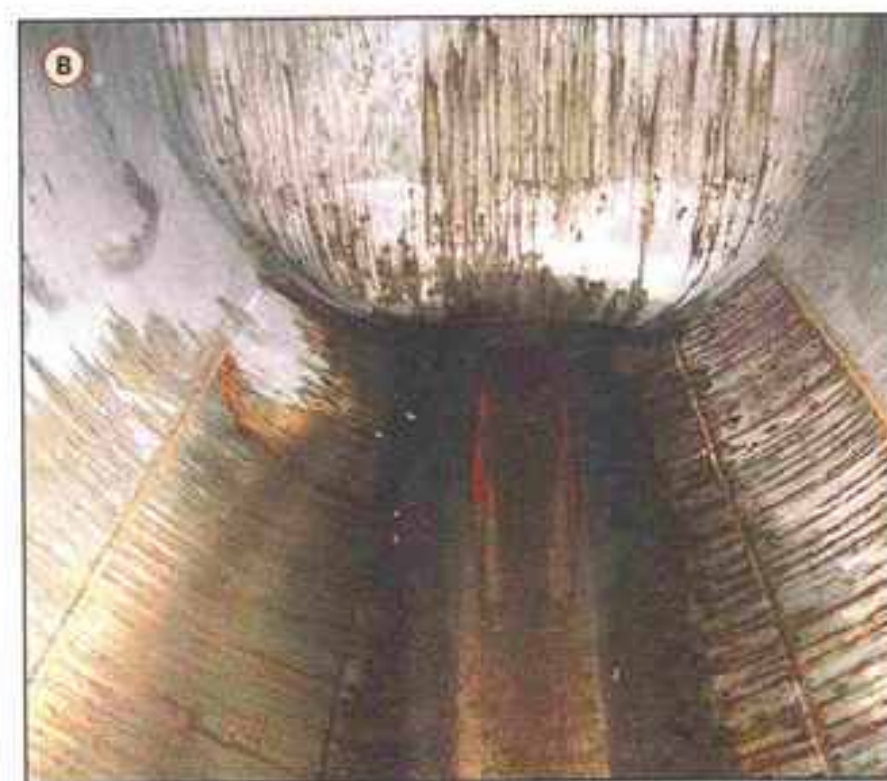
Рис. 3. Характерные повреждения котлов вагонов-цистерн из двухслойных сталей:
