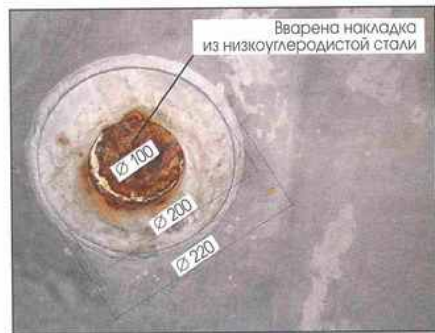
Рис. 4. Дефекты котлов, вызванные ремонтом, выполненным с нарушениями требований нормативных документов
