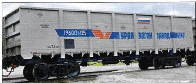
Рис. 3. Универсальный полувагон модели 12-196-01 с разгрузочными люками и нагрузкой на ось 25 тс
