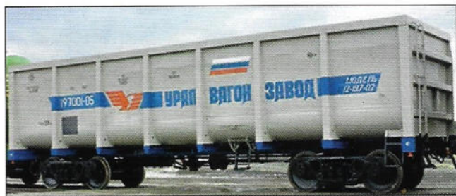
Рис. 4. Полувагон модели 12-197-02 с глухим полом и нагрузкой на ось 25 тс
