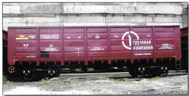
Рис. 1. Универсальный полувагон модели 12-132-03 с межремонтным пробегом до 500 тыс. км
