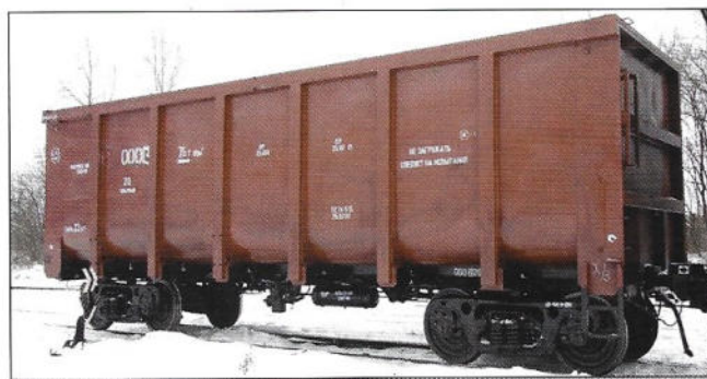
Рис. 6. Полувагон модели 12-2123 с глухим полом и нагрузкой на ось 25 тс
