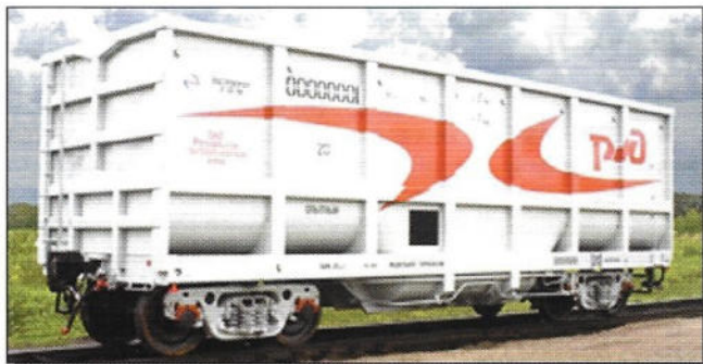
Рис. 7. Специализированный полувагон модели 12-9828 с глухим полом и нагрузкой на ось 27 тс
