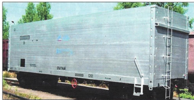
Рис. 8. Полувагон модели ВА2005 с глухим полом и кузовом из алюминиевых сплавов
