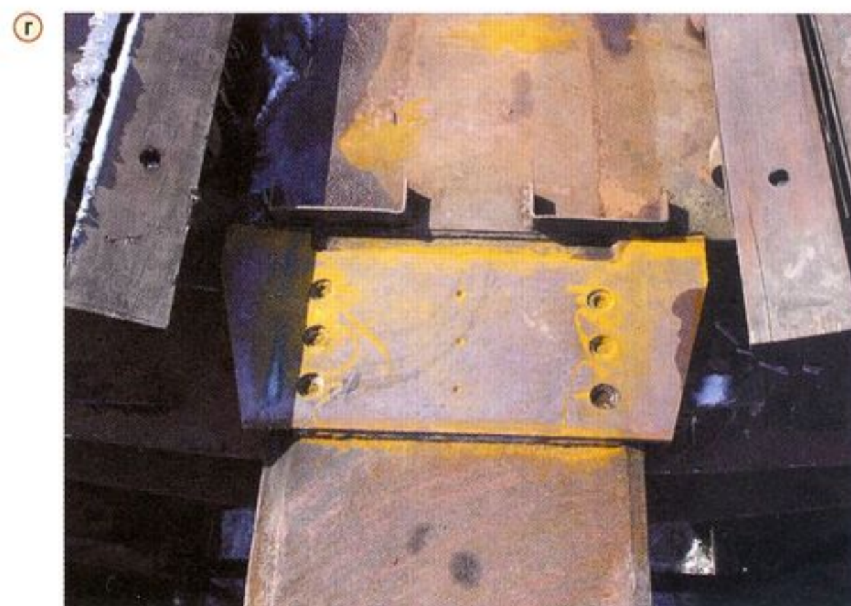
Рис. 5. Общий вид усиления рамы опытного образца вагона-цистерны модели 15-1424 для перевозки олеума: а — консольной части рамы; б — средней части рамы; в, г — шкворневого узла
