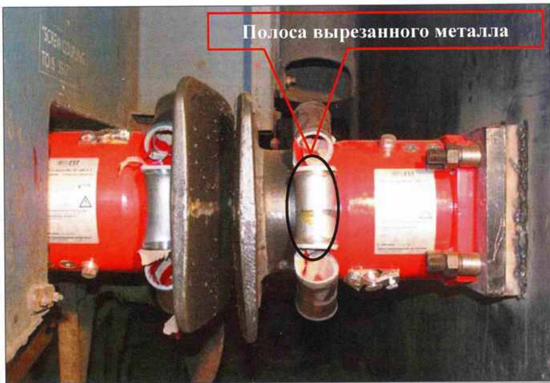
Рис. 4. Буферы с краш-элементами после соударения вагонов
