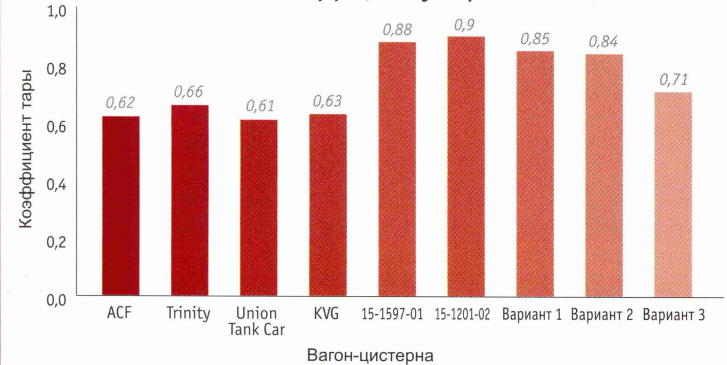
► Рис. 4. Сравнение вагонов-цистерн различных производителей по коэффициенту тары
