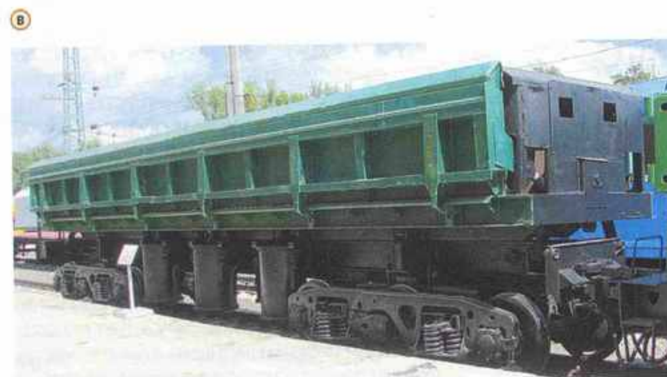
Рис. 1. Общий вид вагона-самосвала: а — четырехосный производства Калининградского вагоностроительного завода; б — четырехосный Демиховского машиностроительного завода; в — шестиосный; г — восьмиосный
