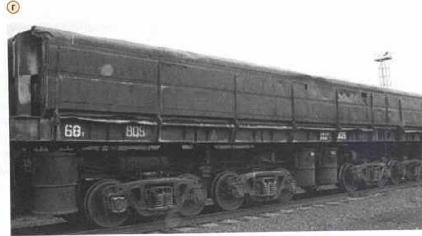
Рис. 1. Общий вид вагона-самосвала: а — четырехосный производства Калининградского вагоностроительного завода; б — четырехосный Демиховского машиностроительного завода; в — шестиосный; г — восьмиосный
