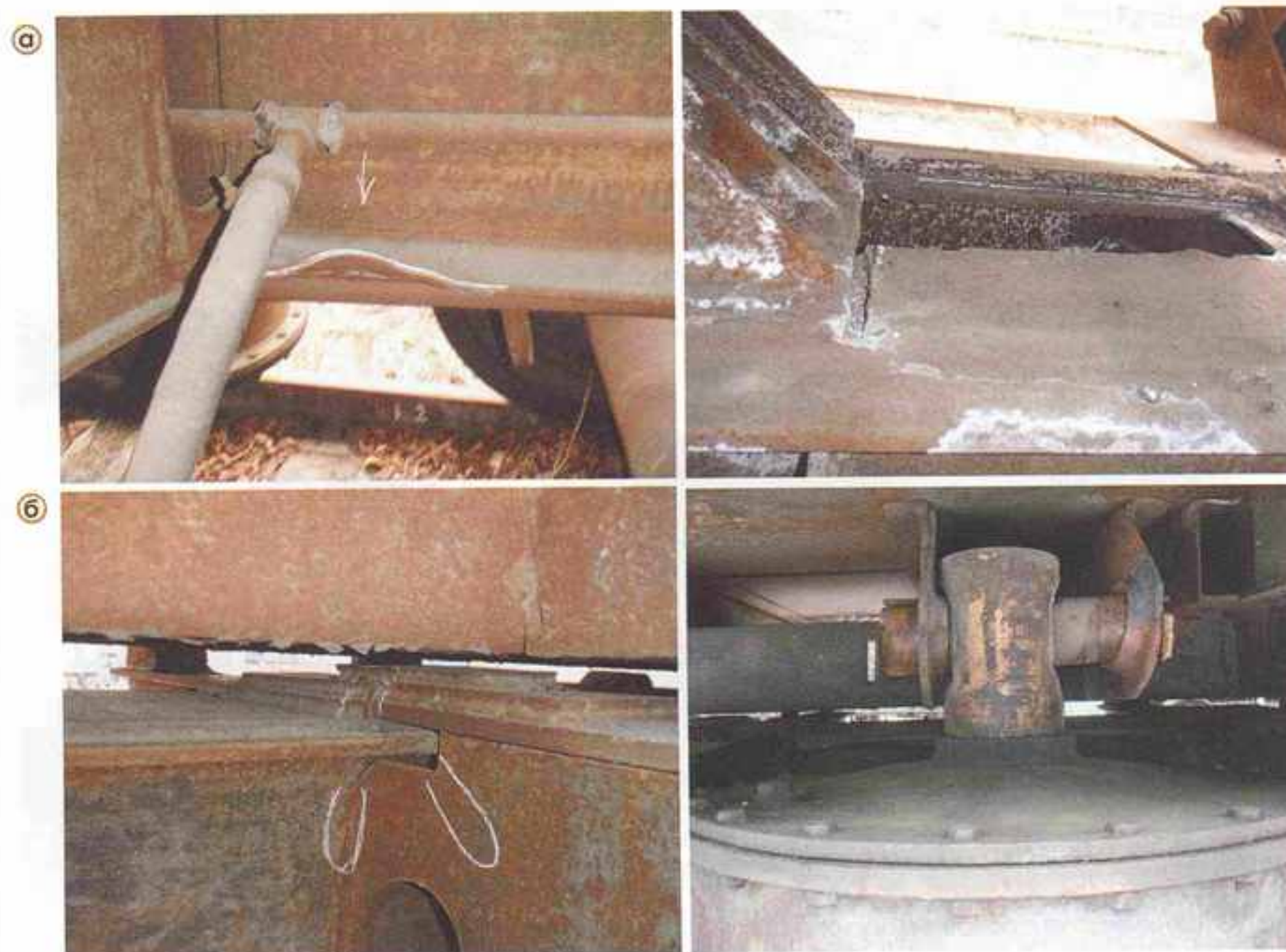
Рис. 2. Техническое состояние рамы вагона-самосвала на момент истечения срока службы: а — повреждения хребтовой балки; б — повреждения шкворневого узла и узла разгрузки
