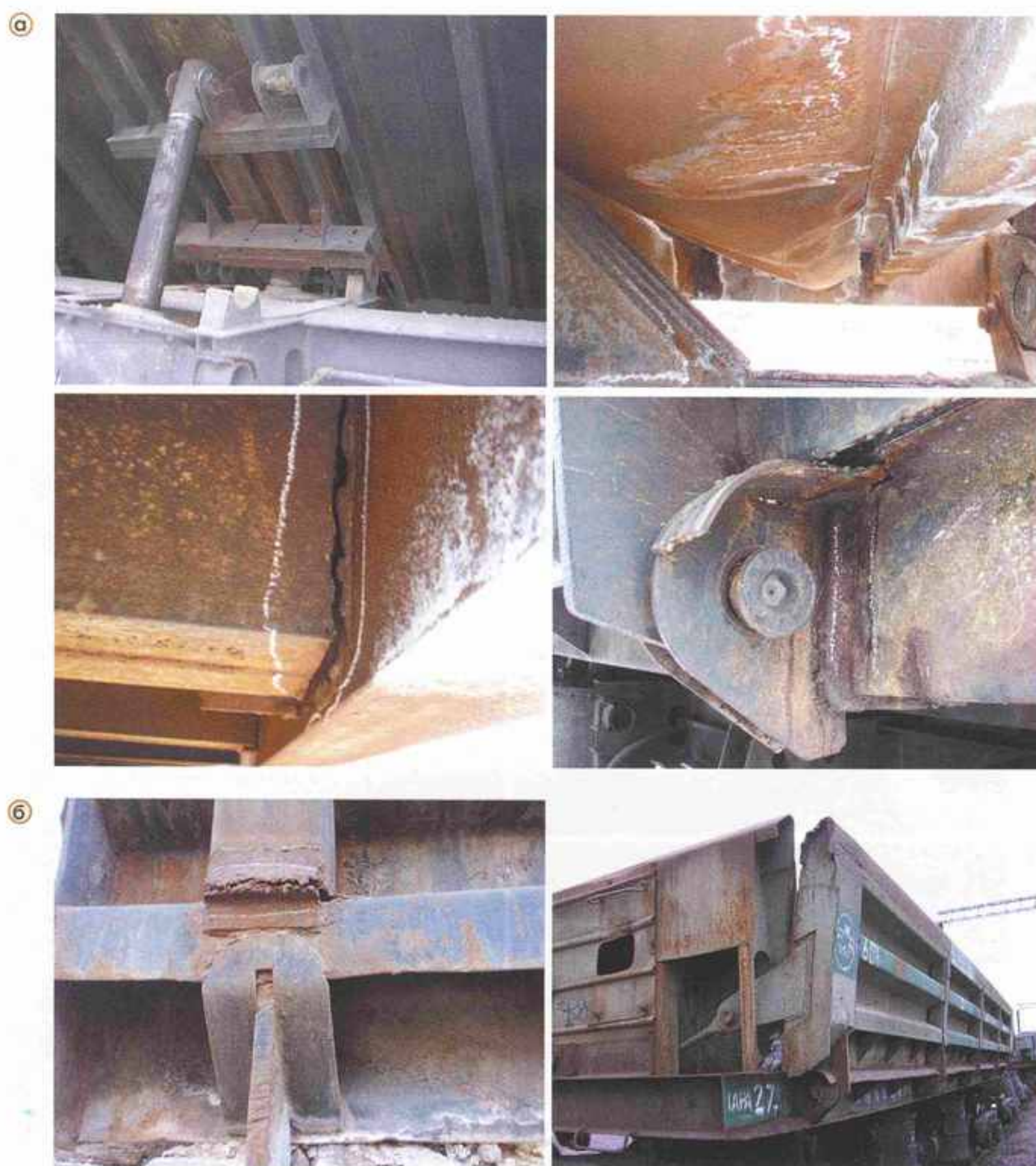
Рис. 3. Техническое состояние кузова вагона-самосвала на момент истечения срока службы: а — повреждения кузова; б — повреждения бортов кузова
